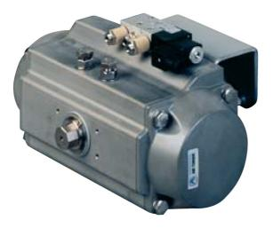
Pour optimiser le pilotage de l'actionneur, il est recommandé d'utiliser l'électro-distributeur dans sa version 5/2 1EV « effet monosépale ». La position au repos est la position « Volet fermé », c'est à dire qu'en cas de coupure d'alimentation électrique le système se mettra en position « volet fermé ».
